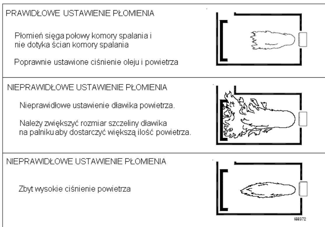
Rysunek 6C- Regulacja długości płomienia
